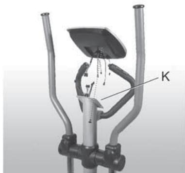
Irrota paristokotelon kansi mittarikotelon takaa ja aseta paristot (2 x 1,5 V AA) paikalleen. Huomioi paristokotelon + ja - merkinnät! Paina paristokotelon kansi takaisin paikalleen.
