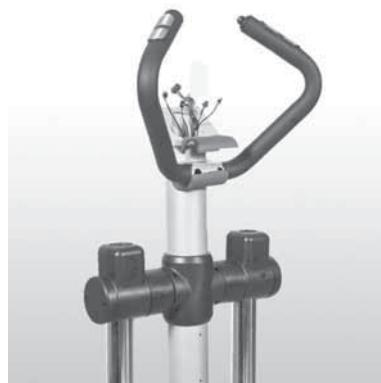
Pujota käsituesta tulevat käspulssijohdot etuputken sisään ja vedä ne etuputken yläpäästä ulos. Kiinnitä käsituki kahdella ruuvilla. **TÄRKEÄÄ!** Varo vahingoittamasta johtoja!
