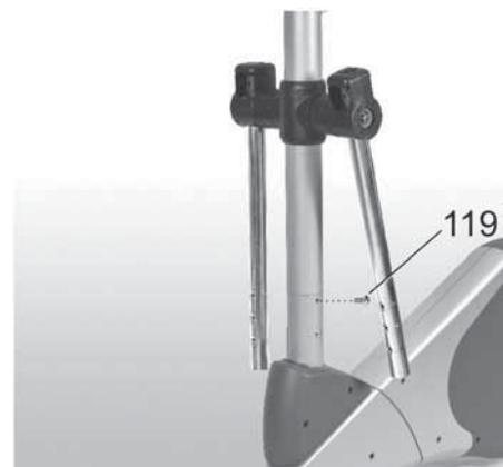
Sluit de kabel van het meettoestel aan de kant van het frame aan op de kabel van het meettoestel in de buis vooraan. Duw de voorste buis in de framebuis: let erop dat u de monitorkabel niet beschadigt! Maak de voorste buis goed vast met zes bevestigingsschroeven.
