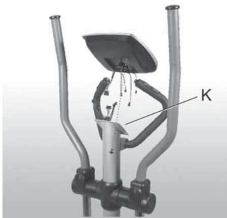
Den Deckel des Batteriefaches auf der Rückseite des Cockpits lösen. Die Batterien (2 x 1,5 V AA) einlegen und auf richtige Polarität achten. Den Deckel wieder anbringen.
