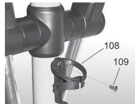
Montieren Sie den Flaschenhalter mit einer Schraube.
