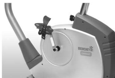
Gire ahora los pedales en la rosca que hay en los brazos de manivela. Atornille el pedal izquierdo (marca L = rosca izquierda) en el brazo de manivela izquierdo. Utilice la llave de tornillos y gire en sentido contrario a las agujas del reloj. Apriete el pedal derecho (marca R = rosca derecha) en el brazo de manivela derecho en el sentido de las agujas del reloj. Por último, fije los pasadores de los pedales a los pedales.
