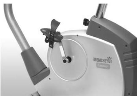
Drehen Sie jetzt die Pedale, in die Gewinde an den Kurbelarmen. Das linke Pedal (Markierung L = Linksgewinde) an den linken Kurbelarm schrauben. Benutzen Sie den Schraubenschlüssel und drehen Sie gegen den Uhrzeigersinn. Das rechte Pedal (Markierung R = Rechtsgewinde) dann am rechten Kurbelarm im Uhrzeigersinn festdrehen. Jetzt noch die Pedalschlaufen an den Pedalen befestigen.
