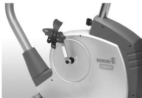
Draai met de pedalen in de schroefdraad aan de krukwangen. Schroef de linkerpedaal (markering L = linkerschroefdraad) aan de linkerkruskwang. Gebruik de schroefsleutel en draai tegen de richting van de wijzers van de klok. Draai dan de rechterpedaal (markering R = rechterschroefdraad) vast aan de rechterkruskwang in de richting van de wijzers van de klok. Bevestig nu nog de pedaallussen aan de pedalen.
