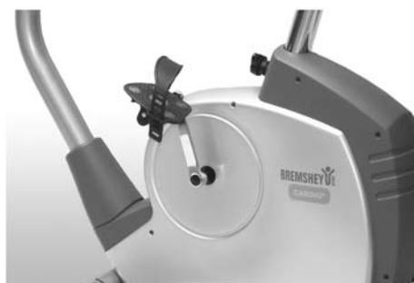
Vissez maintenant les pédales sur les pas de vis de la manivelle. Vissez la pédale gauche (marquée d'un L) à la manivelle gauche. Utilisez un tournevis et tournez dans le sens contraire des aiguilles d'une montre. Vissez la pédale droite (marquée d'un R) à la manivelle droite en tournant dans le sens des aiguilles d'une montre. Fixez ensuite les cale-pieds aux pédales.
