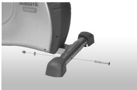
Aseta takatukijalka rungon takaosan alle ja kiinnitä se runkoon kuusiokoloruuveilla, aluslaatoilla ja hattumuttereilla.
