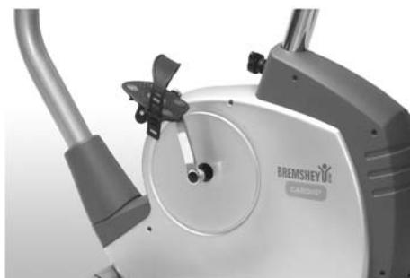
Ruotare ora i pedali avvitandoli al filetto del braccio della pedivella. Avvitare il pedale sinistro (contrassegnato con la lettera L, che indica il filetto di sinistra) al braccio della pedivella sinistra. Utilizzare la chiave e ruotare in senso antiorario. Fissare dunque ruotando in senso orario il pedale destro (contrassegnato con la lettera R, che indica il filetto di destra) al braccio della pedivella destra. Fissare quindi i cinghietti ai pedali.
