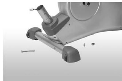
Das Fußrohr vorne in gleicher Weise am Grundrahmen montieren. Achten Sie darauf, dass die Rollen der Fußkappen, die bereits am Fußrohr vormontiert sind, bei der Montage nach vorne und nach unten weisen.
