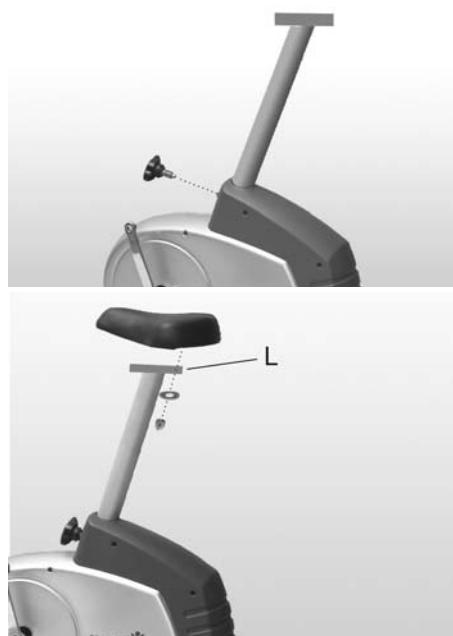
Sätt i sittstödet. Skruva i handhjulet för att justera sätet och låsa handhjulets bult i hålet på sittstödet. Drag därefter åt handhjulet. Sätt fast sätet i sittstödets triangulära monteringsplatta (L) med hjälp av muttrarna och skivorna.
