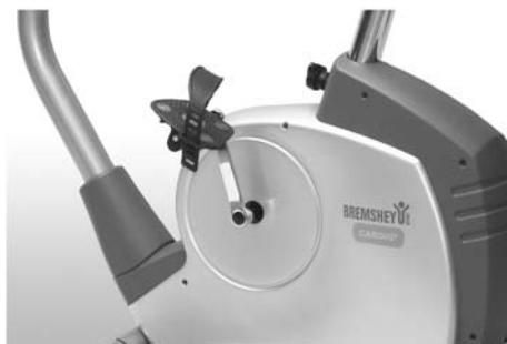
Skruga i pedalerna i vevstångarnas gängor. Skruva vänster pedal (märkt L för vänster gänga) i vänster vevstångar. Använd skiftnyckeln och rotera denna motsols. Skruva därefter höger pedal (märkt R för höger gänga) hårt medsols i höger vevstång. Anslut nu pedalremmarna till pedalerna.
