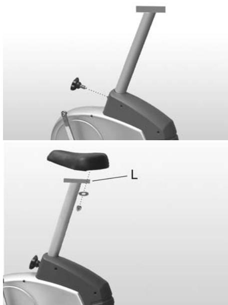
Posez le renfort de selle et ensuite la mollette de réglage et faites encliquer la cheville de la mollette de réglage dans un des orifices du renfort de selle. Serrez la mollette de réglage. Fixez la selle à l'aide des écrous et des rondelles à la plaque de fixation triangulaire (L) du renfort de selle.
