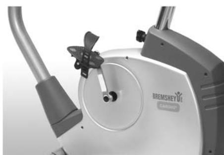
Vissez maintenant les pédales sur les pas de vis de la manivelle. Vissez la pédale gauche (marquée d'un L) à la manivelle gauche. Utilisez un tournevis et tournez dans le sens contraire des aiguilles d'une montre. Vissez la pédale droite (marquée d'un R) à la manivelle droite en tournant dans le sens des aiguilles d'une montre. Fixez ensuite les cale-pieds aux pédales et réglez-les comme souhaité.
