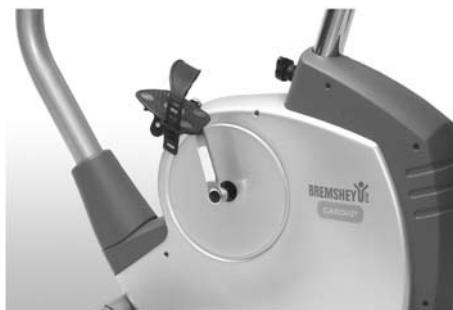
Drehen Sie jetzt die Pedale, in die Kurbelarme. Das linke Pedal (Markierung L = Linksgewinde) an den linken Kurbelarm schrauben. Benutzen Sie den Schraubenschlüssel und drehen Sie gegen den Uhrzeigersinn. Das rechte Pedal (Markierung R = Rechtsgewinde) dann am rechten Kurbelarm im Uhrzeigersinn festdrehen. Jetzt noch die Pedalschläufen an den Pedalen befestigen und wie gewünscht einstellen.
