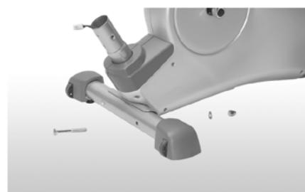
Montare il tubo d'appoggio anteriore sul telaio di base come il tubo d'appoggio posteriore. Prestare attenzione affinché le rotelle dei cappucci dell'appoggio non devono girarsi in avanti o verso il basso durante il montaggio.
