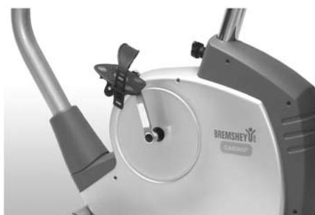
Draait u nu met de pedalen in de crankarm. Schroef de linkerpedaal (markering L = linkerschroefdraad) aan de linker crankarm. Gebruik de schroefsleutel en draai tegen de richting van de wijzers van de klok. Draai dan de rechterpedaal (markering R = rechterschroefdraad) vast aan de rechter crankarm in de richting van de wijzers van de klok. Bevestig nu nog de pedaallussen aan de pedalen en stel ze in volgens uw wensen.
