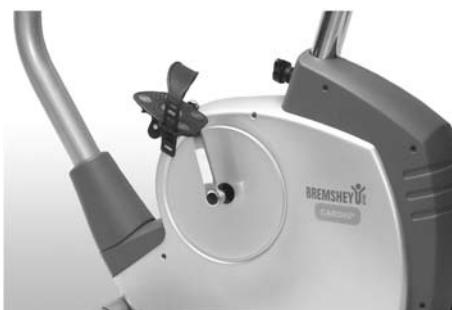
Gire ahora los pedales en el brazo de manivela. Atornille el pedal izquierdo (marca L = rosca izquierda) en el brazo de manivela izquierdo. Utilice la llave de tornillos y gire en sentido contrario a las agujas del reloj. A continuación, atornille el pedal derecho (marca R = rosca derecha) en el brazo derecho de la manivela en el sentido de las agujas del reloj. Fije después los pasadores de los pedales en los pedales y ajústelos como desee.
