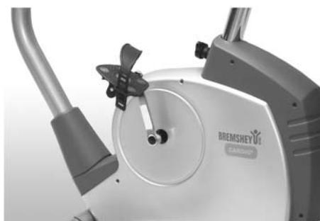
Avvitare ora i pedali sui bracci delle pedivelle. Il pedale sinistro (contrassegnato con la lettera L = filetto di sinistra) deve essere avvitato al braccio sinistro. Utilizzare la chiave e ruotare in senso antiorario. Montare quindi il pedale destro (contrassegnato con la lettera R = filetto di destra) sul braccio della pedivella destra, serrando in senso orario. Fissare quindi i cinghietti ai pedali e regolarli secondo le proprie esigenze.
