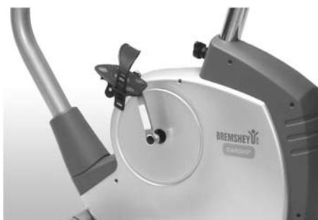
Gire ahora los pedales en el brazo de manivela. Atornille el pedal izquierdo (marca L = rosca izquierda) en el brazo de manivela izquierdo. Utilice la llave de tornillos y gire en sentido contrario a las agujas del reloj. A continuación, atornille el pedal derecho (marca R = rosca derecha) en el brazo derecho de la manivela en el sentido de las agujas del reloj. Fije después los pasadores de los pedales en los pedales y ajústelos como desee.
