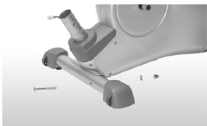
Montare il tubo d'appoggio anteriore sul telaio di base come il tubo d'appoggio posteriore. Prestare attenzione affinché le rotelle dei cappucci dell'appoggio non devono girarsi in avanti o verso il basso durante il montaggio.
