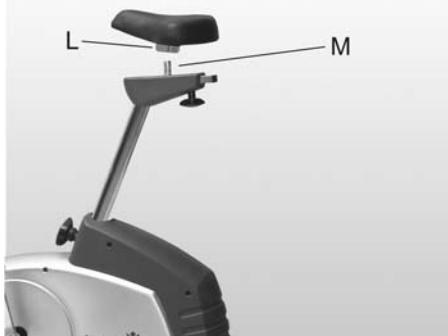
För in sittstödet. För in handhjulet för att justera sätet och fästa handhjulets bult i ett hål på sittstödet. Drag därefter åt handhjulet. För att
